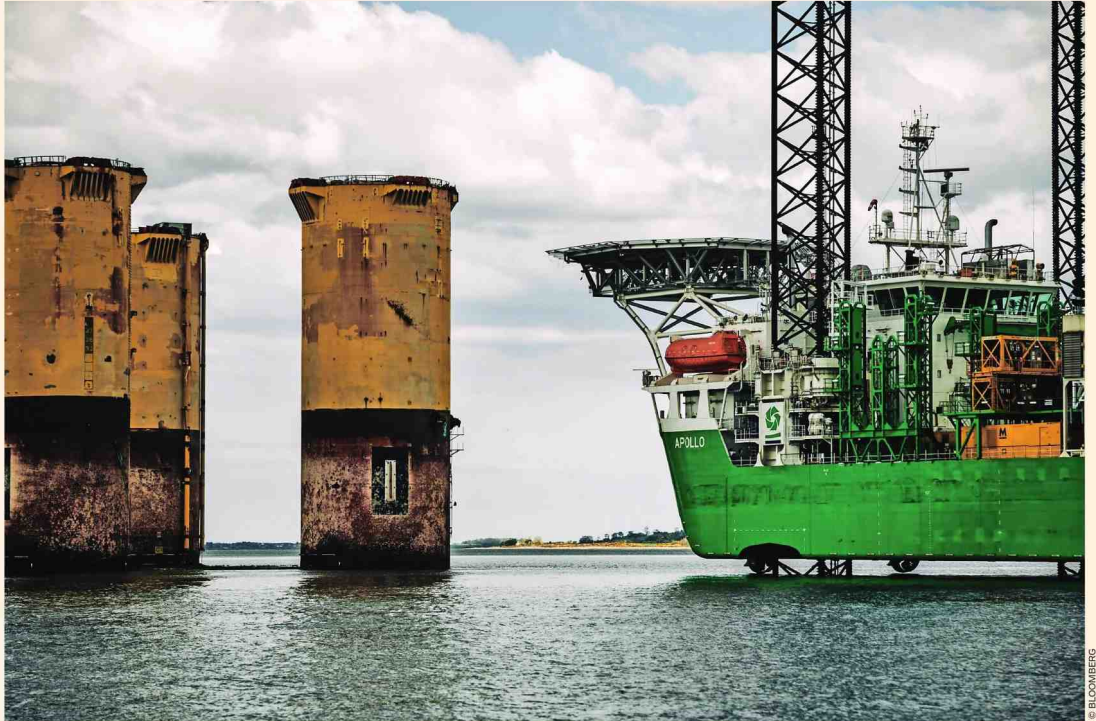
De Apollo, een windmoleninstallatieschip van DEME. Drijvende windturbines kunnen op veel meer plekken geplaatst worden dan windturbines met funderingen.
