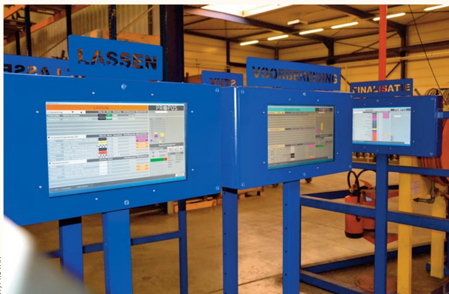
Elke productiecel is uitgerust met een touch screen waarop de operatoren een overzicht krijgen van de opdrachten die hun richting uitkomen.
