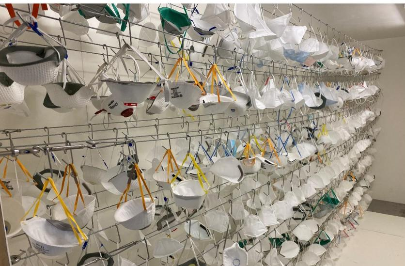
Le « Clean Mask Decontamination Room » ou CMDR est une solution mobile conçue pour le nettoyage à grande échelle des masques FFP2 et FFP3.
