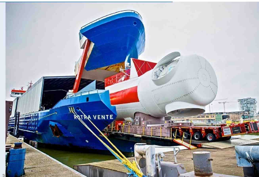
Om de gondel aan wal te krijgen, investeerde Haven Oostende in een drijvende laad- en losinstallatie.
